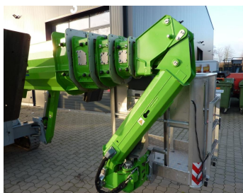
Teupen LEO 31T, 10001936- drehbarer Korb
